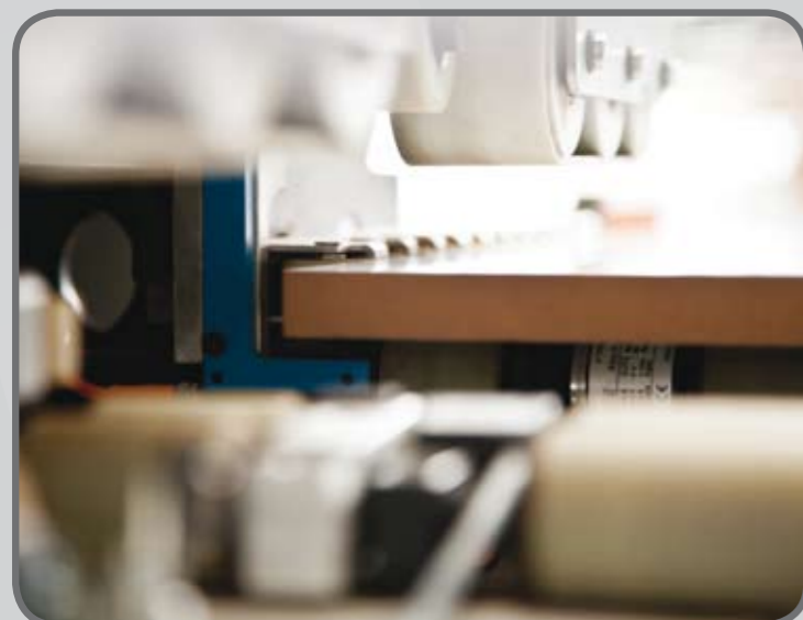
Fotocellula laser per la lettura di origine e fine pannello.
