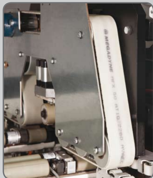
Cinghia brevettata che consente una movimentazione pannello senza soluzione di continuità e senza danneggiare i pannelli.
