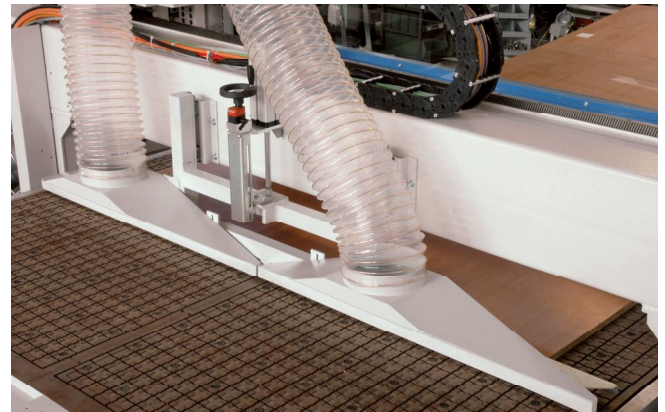
Вспомогательное разгрузочное устройство: позволяет выталкивать обработанные детали с рабочего стола, который затем очищается при помощи "пылесоса" (опц.) Urządzenie pomocnicze do rozładowania obrobionych elementów ze stołu maszyny i jego oczyszczenia (opcja). Panel Boşaltma Ünitesi : İşlenmiş parçaları makine üzerinden otomatik olarak sıyrırken aynı anda çalışma tablasını temizleyerek makinenin tablasını yeni işlenecek malzeme için hazır hale getirir. (Opsiyonel)
