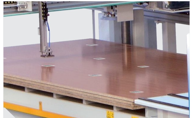
Маркировка устройств: он печатает этикетки и придает их автоматически на панелях расположенных на грузовой платформе. Drukowanie urządzeń: drukuje etykiety i dołącza je automatycznie na panelach umieszczonych na platformy ładujące. Cihaz Baskı: bu etiket yazdırır ve otomatik olarak yükleme platformu üzerinde konumlandırılmış panel üzerindeki etiketleri ekler.
