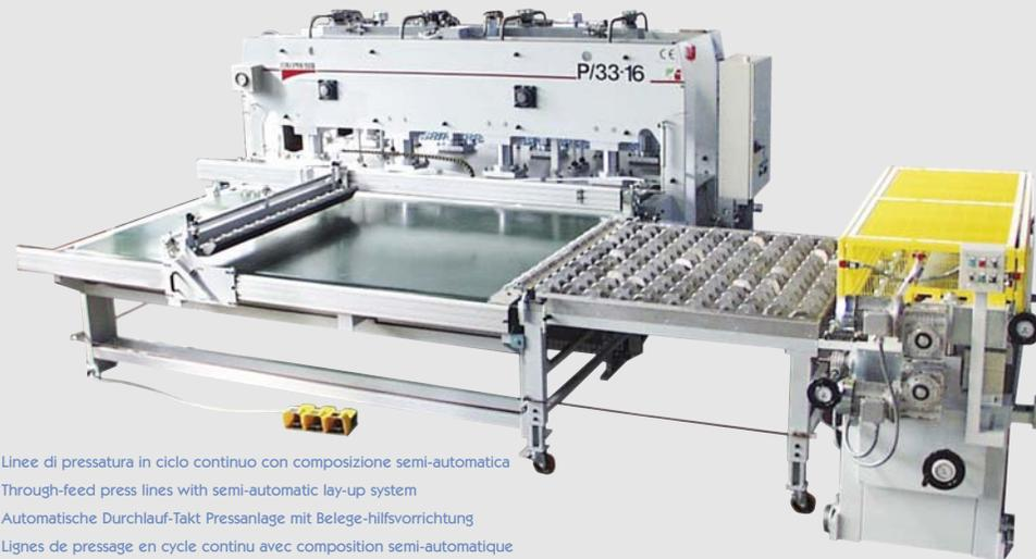
Linee di pressatura in ciclo continuo con composizione semi-automatica
