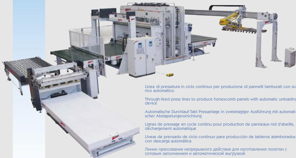
Linee di pressatura in ciclo continuo per produzione di pannelli tamburati con scarico automatico
