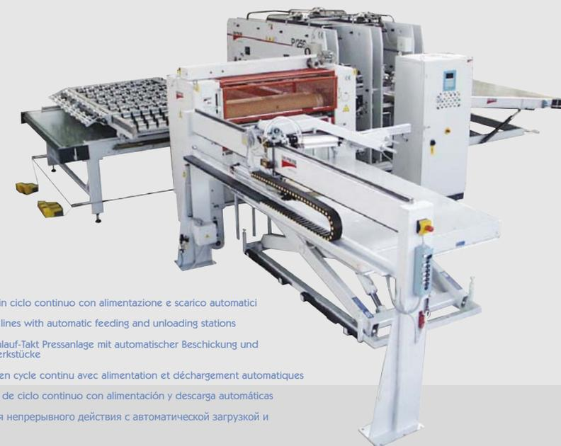
Linee di pressatura in ciclo continuo con alimentazione e scarico automatici
