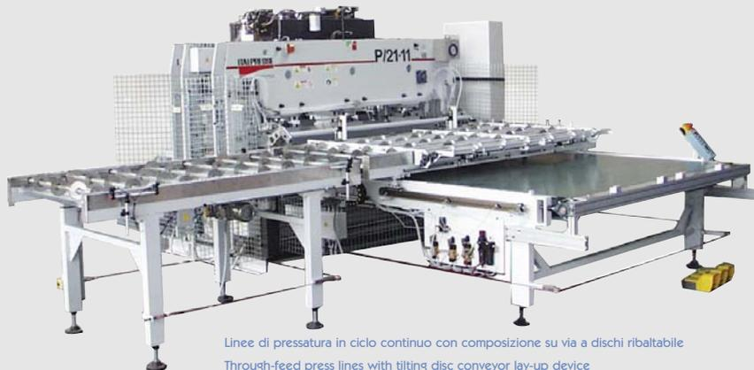
Linee di pressatura in ciclo continuo con composizione su via a dischi ribaltabile
