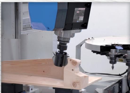
Электрошпиндель с жидкостным охлаждением
