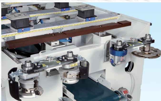
Магазин для автоматической смены инструмента расположен на каретке; магазин под инструмент больших размеров расположен справа на станине станка.
