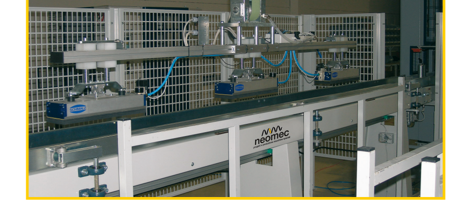
Axel con gruppo di presa a pinze. Axel with gripping unit.
