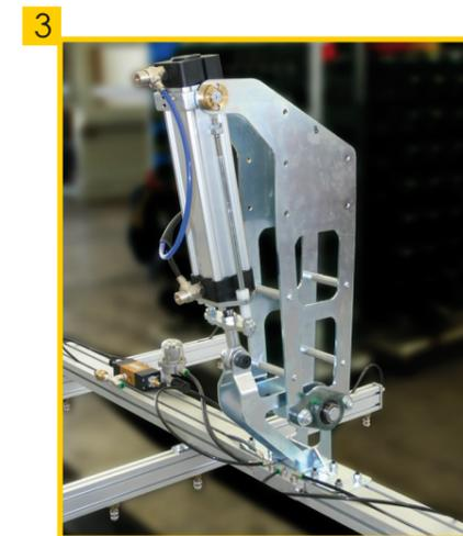
Rotazione telaio a ventose con cilindro pneumatico.
