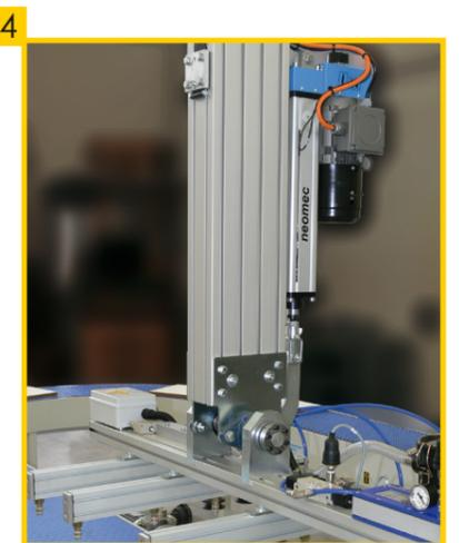
Rotazione telaio a ventose con attuatore a controllo elettronico.
