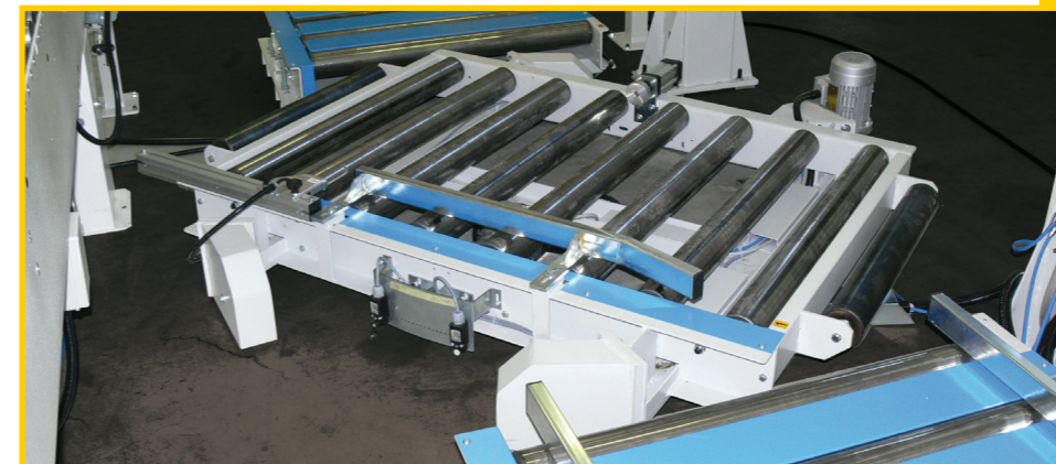
5 Carrello di deposito rotante. Rotating storage trolley.
