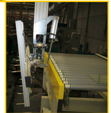
3 Brio con gruppo di presa inclinabile per lastre vetro. Brio with tilting gripping unit for sheets of glass.
