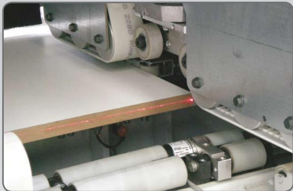
Doppio "zero" ; uno tramite riferimento meccanico per lettura dell'origine del pannello ed il secondo tramite fotocellula laser per la lettura automatica di fine pannello. Con questo dispositivo la Point 2 corregge automaticamente errori di taglio ed assicura un perfetto assemblaggio fra pannello orizzontale e pannello verticale.
