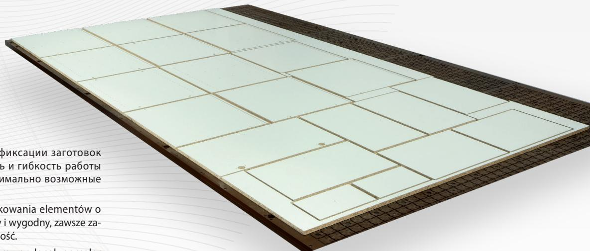
Матричный рабочий стол для фиксации заготовок любой формы. Универсальность и гибкость работы станка позволяет получить оптимально возможные расположения деталей.
