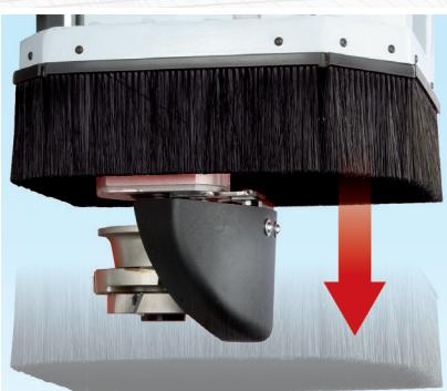
Управляемый ЧПУ аспирационный кожух с регулируемой высотой (стандартно) и установленный на инструменте дефлектор для отвода стружки (опционально) в целях оптимизации работы системы аспирации.
