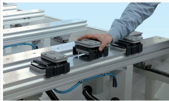
Вакуумная система крепления присосок значительно сокращает время подготовки рабочего стола к работе.
