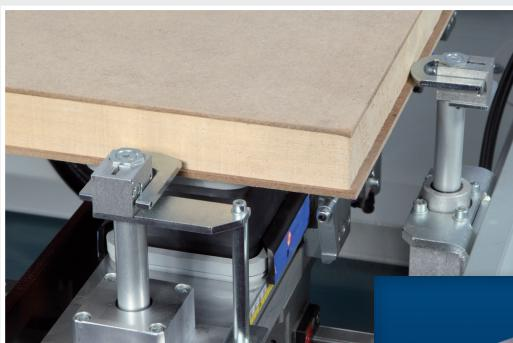
Нулевые упоры для деталей с или без выступающей кромки.
