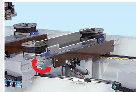
Пневматически поднимаемые и опускаемые вспомогательные подающие устройства для упрощения позиционирования тяжелых заготовок.
