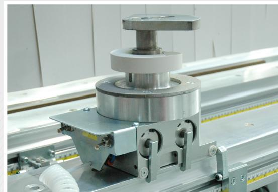
Механические зажимные устройства для обработки заготовок из массива, для линейных и арочных элементов.
