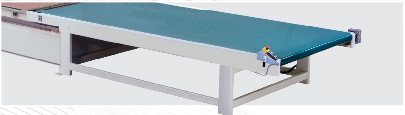
Система разгрузки деталей при помощи приводного транспортера: позволяет, совместно со вспомогательным разгрузочным устройством, автоматически выталкивать обработанные элементы с рабочего стола к оператору, который затем складывает их вручную.
