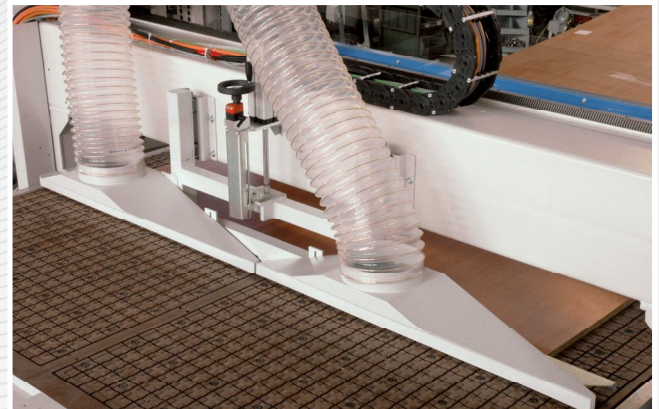
Вспомогательное разгрузочное устройство: позволяет выталкивать обработанные детали с рабочего стола, который затем очищается при помощи "пылесоса" (опц.) Urządzenie pomocnicze do rozładowania obrabionych elementów ze stołu maszyny i jego oczyszczenia (opcja). Panel Boşaltma Ünitesi : İşlenmiş parçaları makine üzerinden otomatik olarak sıyrırken aynı anda çalışma tablasını temizleyerek makinenin tablasını yeni işlenecek malzeme için hazır hale getirir. (Opsiyonel)
