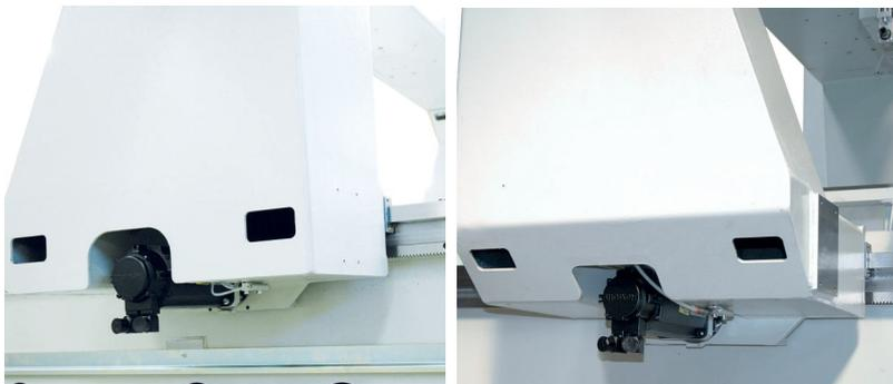
Перемещение по высококачественным и прецизионным направляющим. Бесщеточные двигатели и линейные направляющие с высококачественными и прецизионными шариковыми подшипниками на каждой оси.
