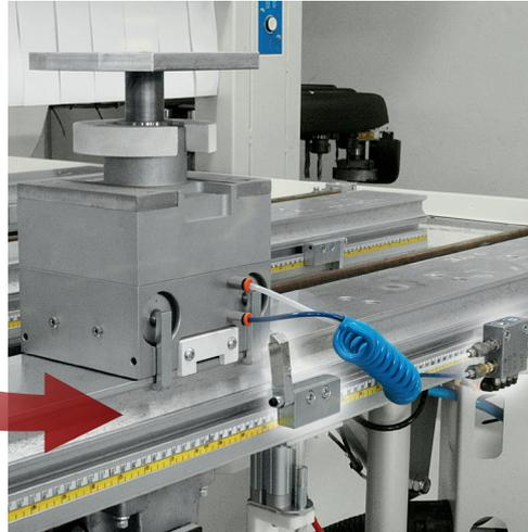
Механические зажимные устройства для обработки заготовок из массива, для линейных и арочных элементов
