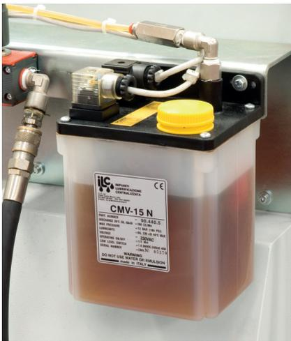
Управляемая ЧПУ автоматическая централизованная смазка всех подвижных частей станка.
