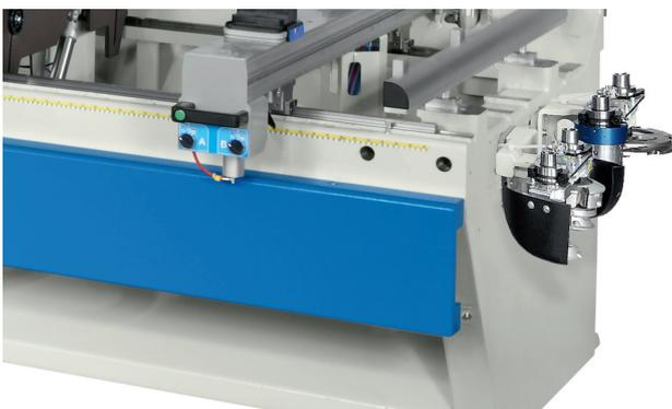
Широкий выбор магазинов для автоматической смены инструмента позволяет также размещать инструмент больших диаметров".
