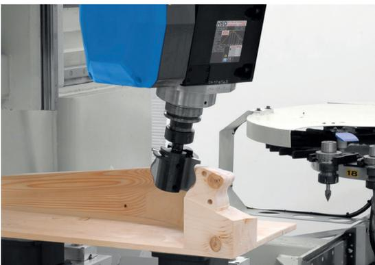
Электрoшпindleль с жидкостным охлаждением
