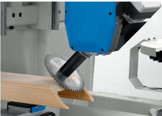
Фрезерный узел с взаимоположенными направлениями вращения для 5-осной обработки
