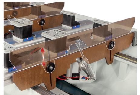
Пневматически поднимаемые и опускаемые вспомогательные подающие устройства, облегчающие позиционирование тяжелых заготовок.
