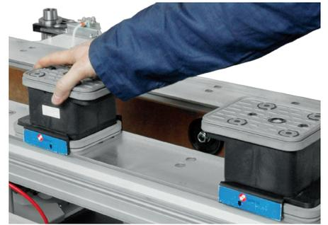
Вакуумная система крепления присосок значительно сокращает время подготовки рабочего стола к работе.
