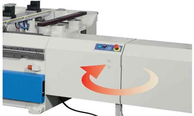
Дверца, позволяющая заходить за защитное ограждение и выполнять техническое обслуживание оборудования.
