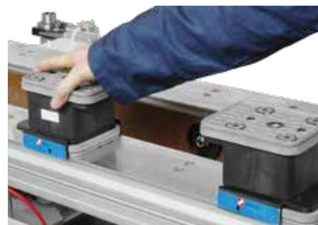
Вакуумная система крепления присосок значительно сокращает время подготовки рабочего стола к работе.
