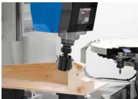
Электрошпиндель с жидкостным охлаждением
