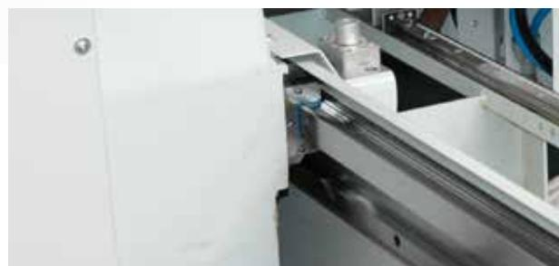
Перемещение по высококачественным и прецизионным направляющим. Бесщеточные двигатели и линейные направляющие с высококачественными и прецизионными шариковыми подшипниками на каждой оси.
