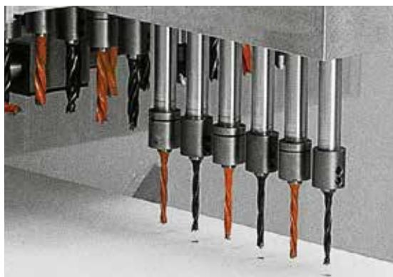
Сверлильная голова, электрошпиндель с воздушным охлаждением, фрезерные узлы, пильный узел, многопозиционный магазин инструмента для наиболее оптимального использования оборудования
