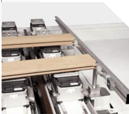
Stół roboczy wyposażony w ruchome bazy boczne
