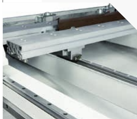
System mocowania stołów roboczych za pomocą łożyska z tulejami kulkowymi
