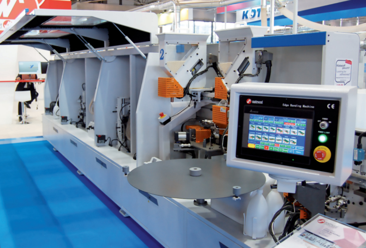
Przemysłowe oklejarki serii MasterEdge wyposażone w 2 zbiorniki klejowe, do ciągłej pracy z prędkością 23 m/min.
