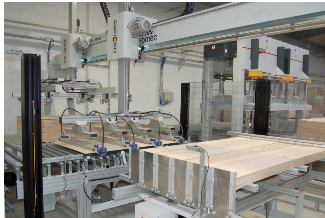
Linia do kompozycji podłogi 2 warstwowej w stos oraz automatycznego prasowania.
